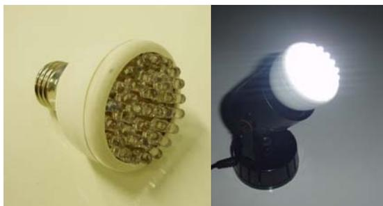
Figura 11. Protótipo da lâmpada com 36 LEDs.
